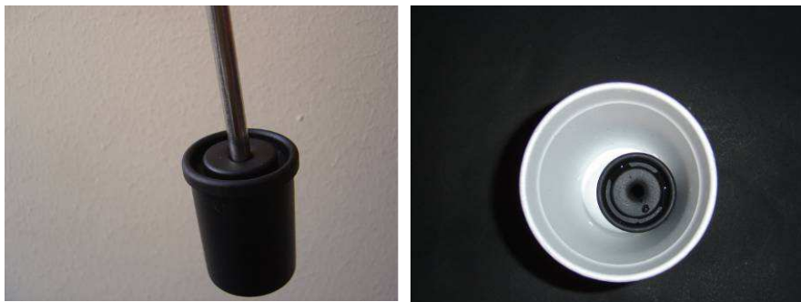
Εικόνα 4: Το φωτογραφικό κόνιστρο με το ζεστό νερό και τον αισθητήρα θερμοκρασίας και το ποτήρι με το κρύο νερό στο οποίο έχει εμβαπτιστεί το κόνιστρο.
