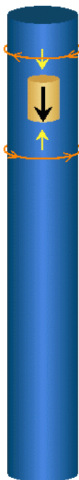
Εικ.1. Πτώση του μαγνήτη με τον βόρειο πόλο προς τα κάτω. Πηγή: 4PHYSICS.COM
